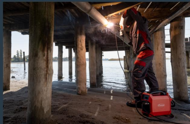
Con una carga de batería se pueden soldar 30 electrodos de 2,5 mm.
