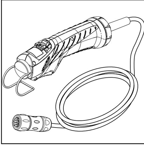
RC Bar iJob / TMC uzaktan kumanda ünitesi ile aynı parametreler bir JobMaster torç gibi ayarlanabilir.
