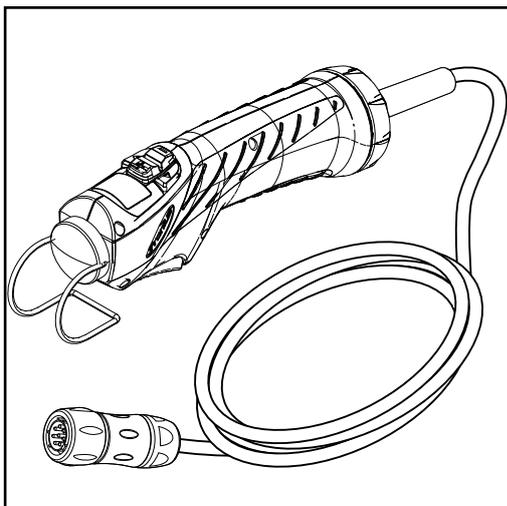
リモート制御 RC Bar iJob / TIG マルチコネクタを使用すると、ジョブマスターの溶接トーチと同様のパラメータを設定できます。
