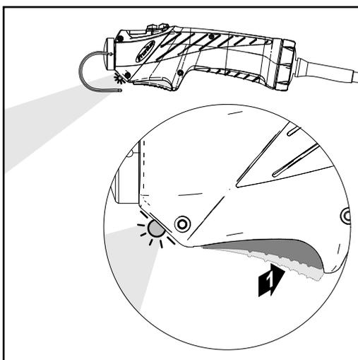
Функция горелки, когда кнопка находится в положении 1 (кнопка горелки нажата наполовину):
