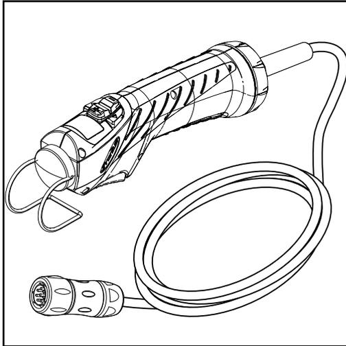
使用 RC Bar iJob / TIG Multi Connector 遥控器，可设置与 JobMaster 焊枪相同的参数。
