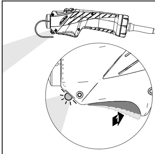
焊枪起动装置处于开关位置 1 时（半按焊枪起动装置）的功能:
