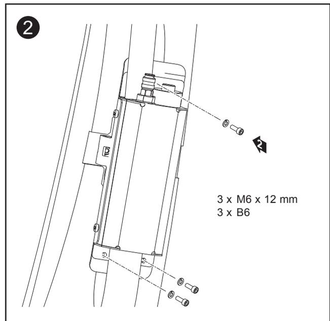
B6, B8 = Federring / lock washer / rondelle élastique
