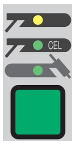
**1** Mit der Taste Verfahren das Verfahren Stabelektroden-Schweißen auswählen
