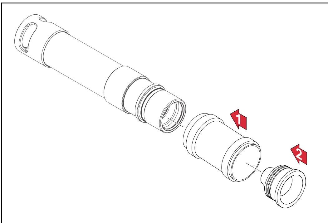
Die Montage des Wellendichtrings und der Überschubmuffe am Exentometer ist nur bei der Volumenstrom-Messung an Fremdfabrikaten erforderlich.
