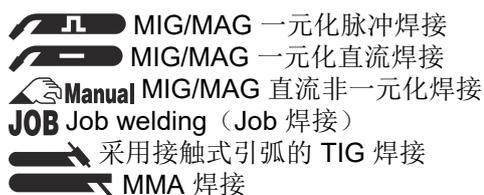
**重要!** 如果 VR 7000 送丝机已连接 TS 4000/5000 电源, 则 MIG/MAG 一元化脉冲焊接不可用。
