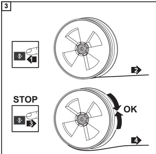
Bremse einstellen: bei D300 Gerät
