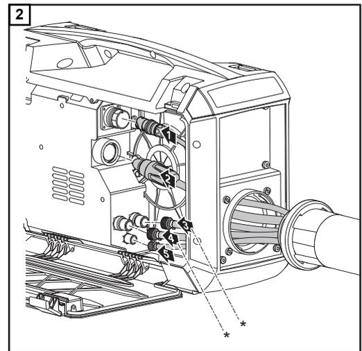
\* nur wenn die Kühlmittel-Anschlüsse im Drahtvorschub eingebaut sind und bei wassergekühltem Schweißbrenner
