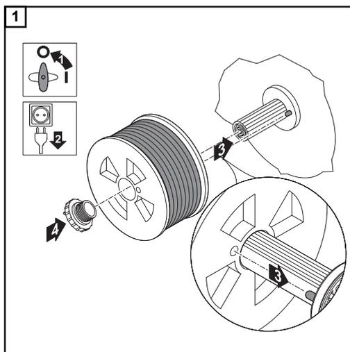
**Drahtspule einsetzen: bei D300
