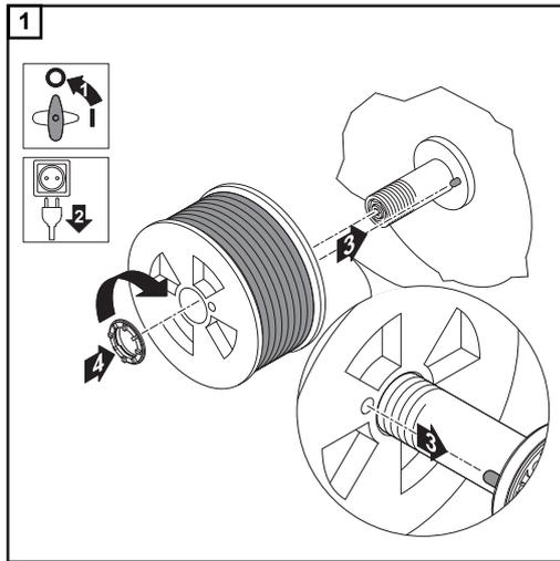
**Korbspule einsetzen: bei D300
