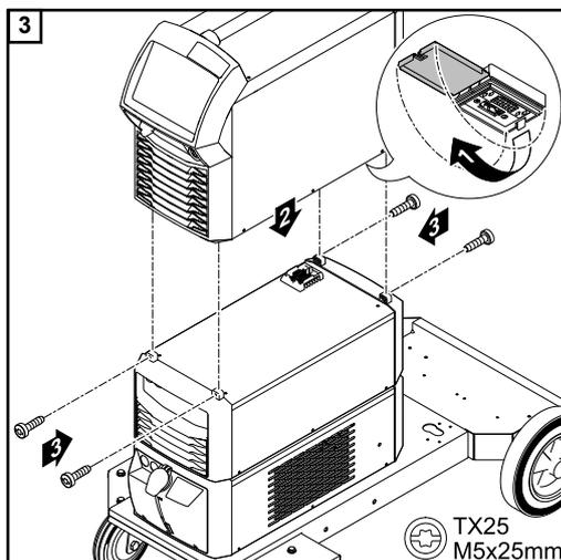
Parafusar o dispositivo do refrigerador e fonte de solda em um console
