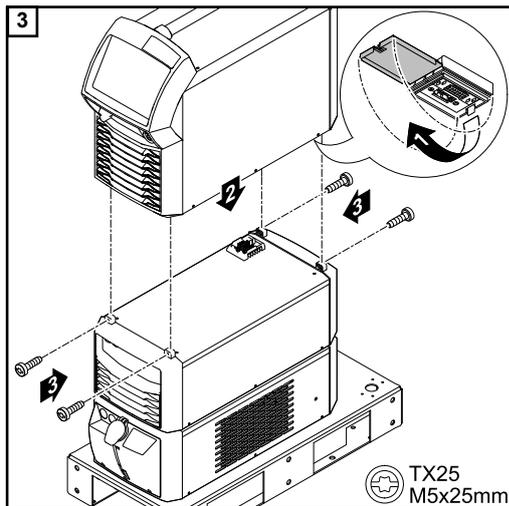
Parafusar o dispositivo do refrigerador e fonte de solda em dois consoles
