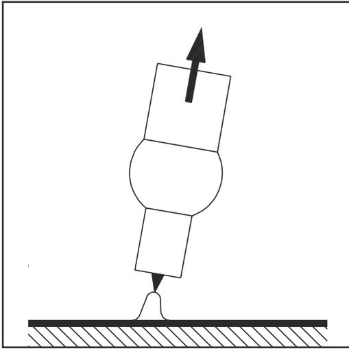
4 Levantar a tocha de solda e levar para a posição normal
