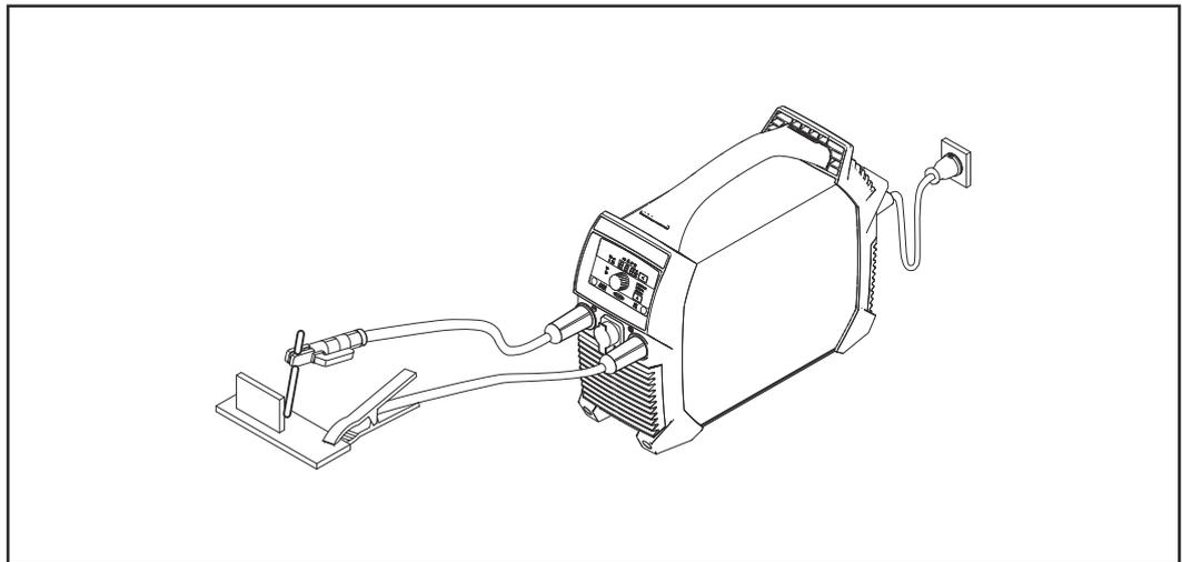
Soldagem de eletrodos revestidos
