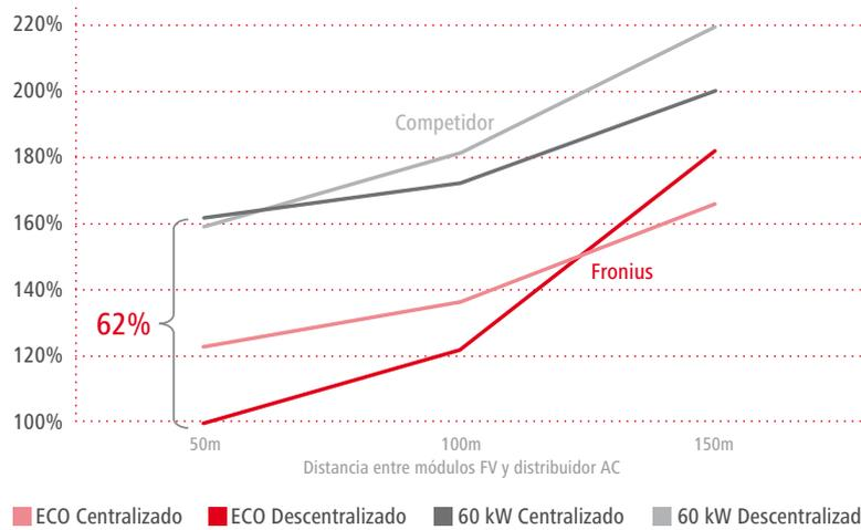
Comparaciones con otros inversores 60 kW, dispuestos de manera centralizada o descentralizada, revelan que el Fronius Eco de 27 kW tiene un coste-beneficio del 62%. Este ahorro es resultado de diferencias en el cableado y los componentes necesarios para distribución AC y DC. La distancia entre el inversor y el distribuidor AC es también relevante.
