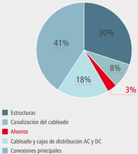
El diseño del sistema inteligente del Fronius ECO te permite ahorrar más de un 3 % en costes BOS
