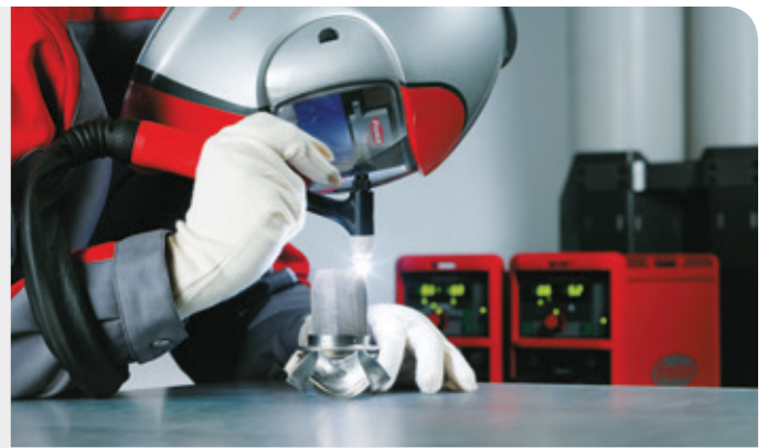
/ Manuelles Mikroplasma-Schweißen für Blechdicken ab 0,1 mm.
